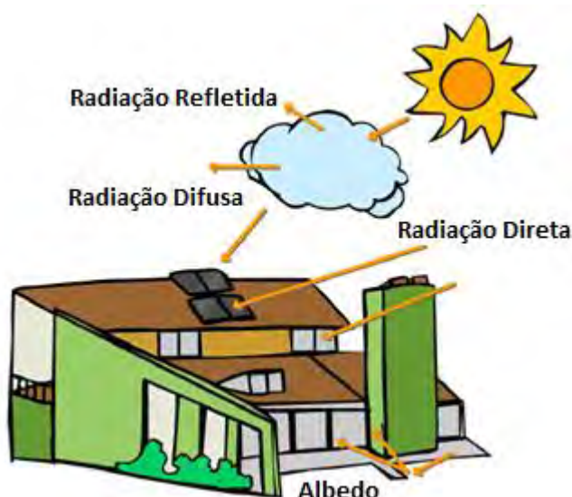
Figura 4 - Três componentes da radiação solar
