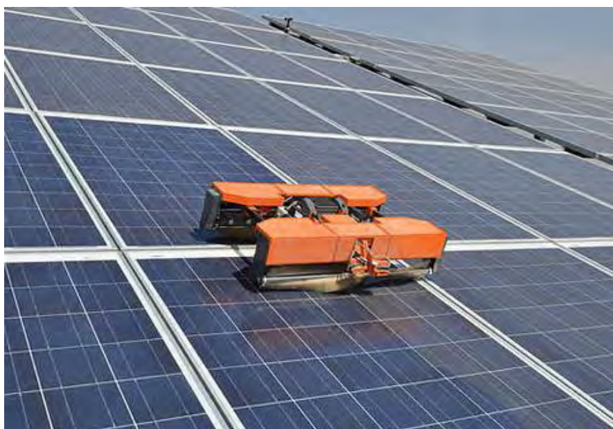
Figura 33 - Robô inteligente executando a limpeza dos módulos fotovoltaicos
